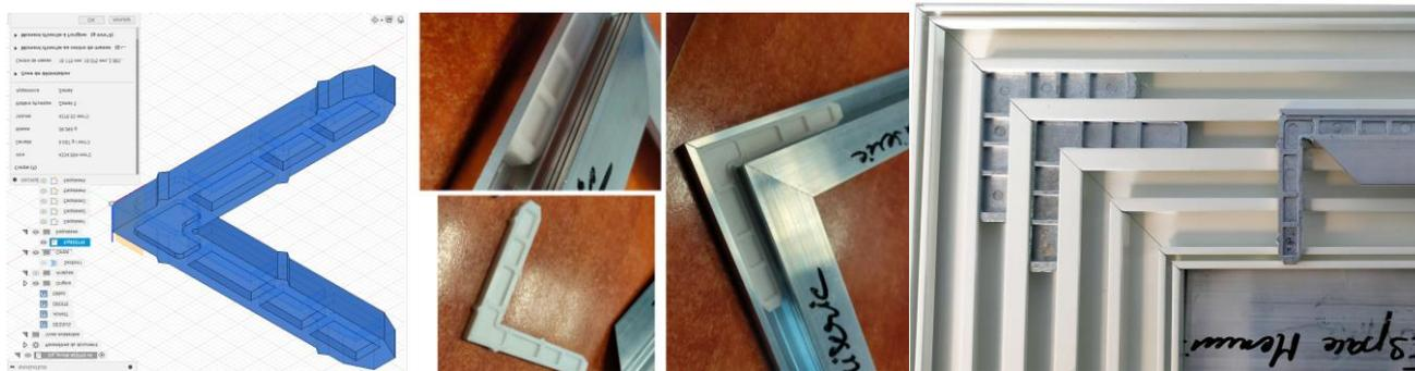
Les différentes phases : conception, prototypage et assemblages des équerres zamak de production dans les profils de la menuiserie
