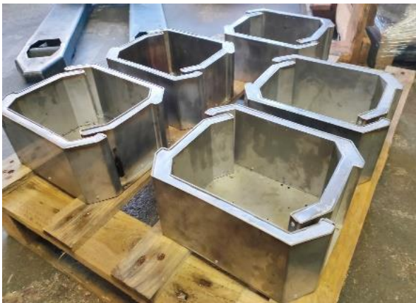
Remplissage des labyrinthes réalisés en tôleries fines avec du plomb
