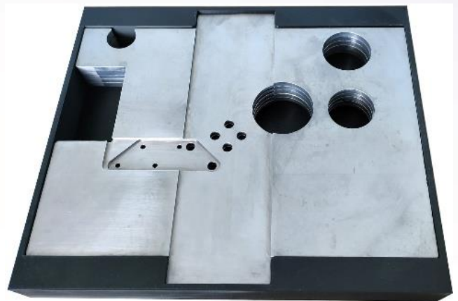
Usinage de plaques couvercles avec un alliage de plomb
